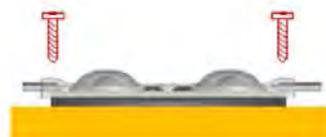
Pulire e sgrassare la superficie di posizionamento del modulo a LED per consentire al biadesivo di far presa correttamente
